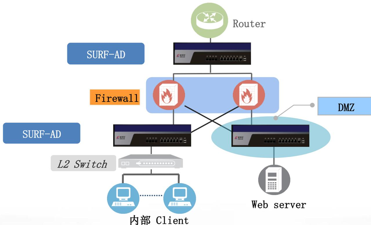
冗余的防火墙，提高可用性和可靠性，在DMZ区，同样可以配置为负载均衡
