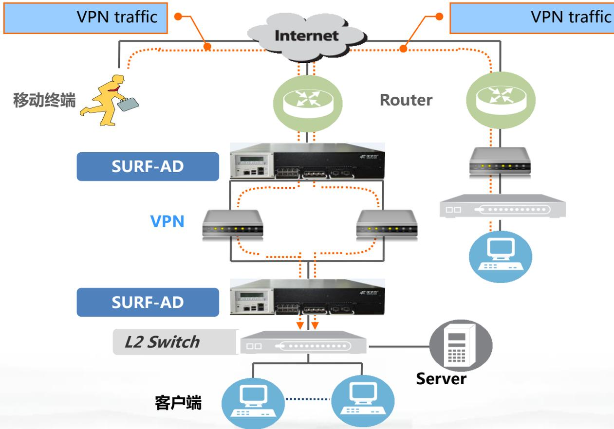
对VPN隧道可以进行负载均衡，冗余的VPN可以增加稳定性
